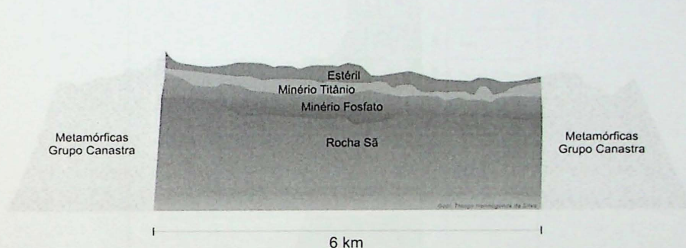
Figura 7. Perfil da zona mineralizada do Complexo de Tapira, mostrando a discriminação em distintas zonas geoquímicas, incluindo as mineralizadas em fosfato e titânio (Vale Fertilizantes, 2013).
