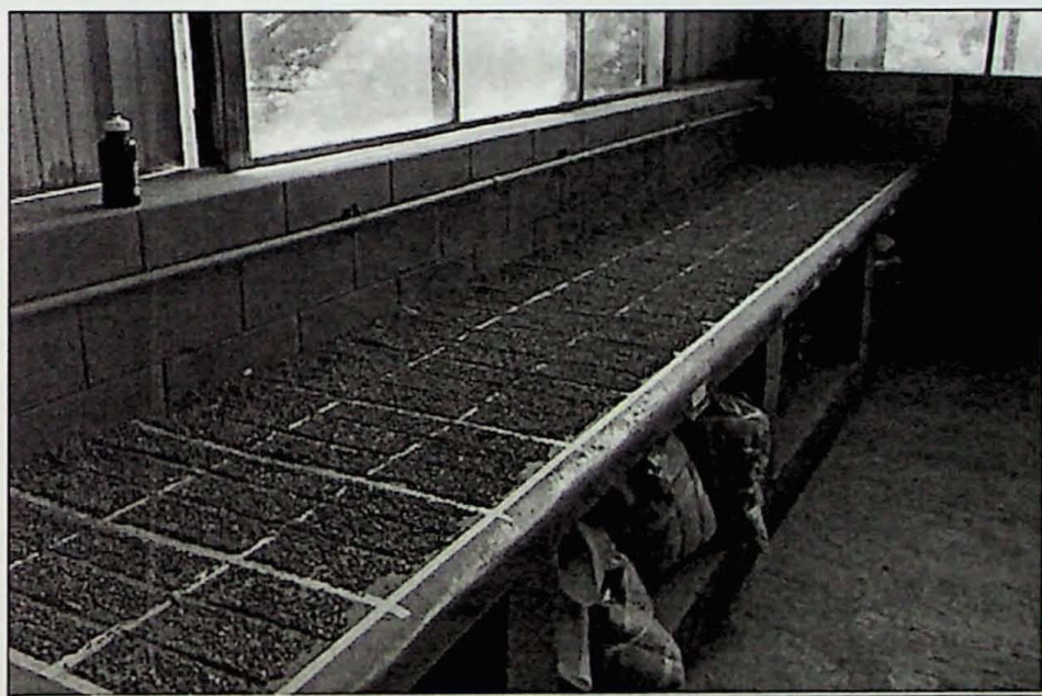
Figura 15. Foto de parcela da matriz 10 \times 45 utilizada na composição dos grupos da menor fração para execução do Teste de Heterogeneidade – Metodologia Indireta.
