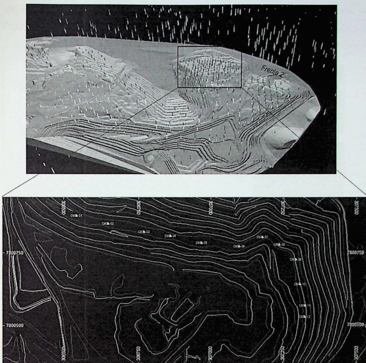
Figura 13. Localização da Frente 2 ("Região da Bigorna") vista em perspectiva (acima) e em planta (abaixo), mostrando os 12 pontos de amostragem no banco 1230.
